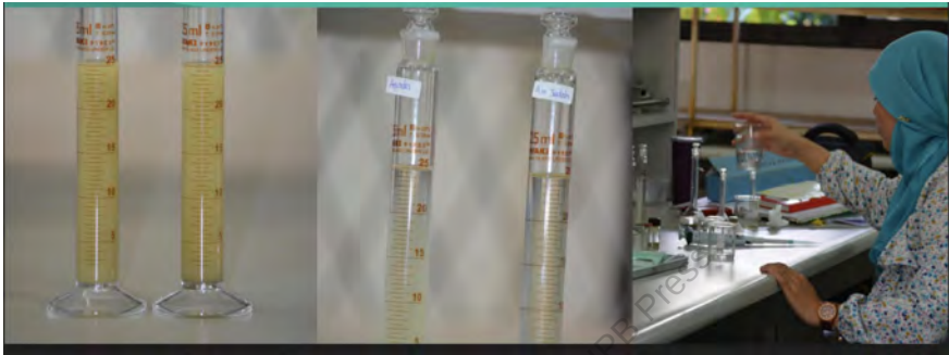
Gambar 35. Proses uji kestabilan formulasi
