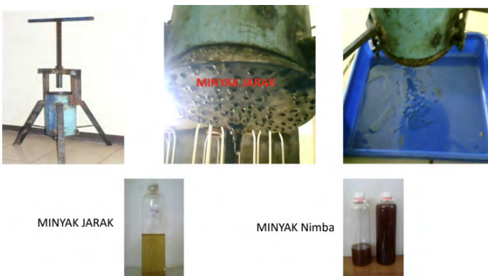
Gambar 8. Hasil ekstraksi dengan teknik pressing
