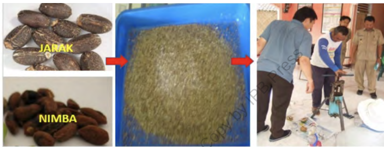
Gambar 7. Ekstraksi dengan teknik pressing
