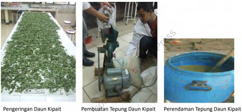
Gambar 5. Proses pembuatan ekstrak daun kipait
