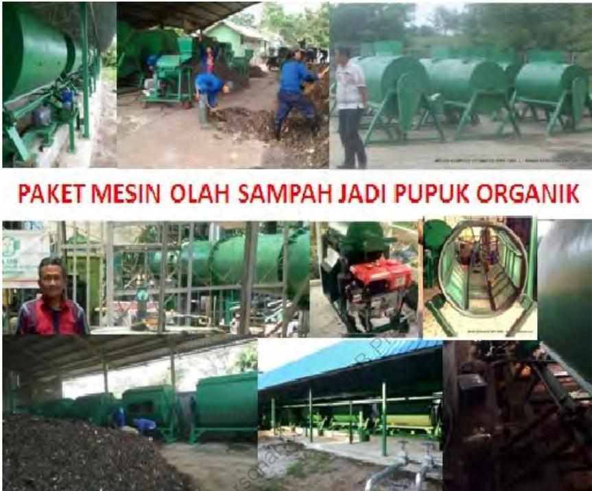
Gambar 41. Mekanisasi pengomposan limbah perkotaan
