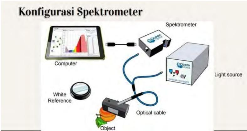
Gambar 90. Konfigurasi spektrometer
